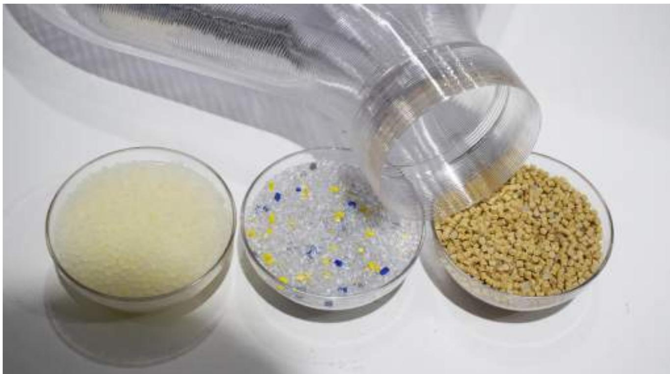
使用的 PETG 材料是一种环保型的材料。已经成为一个不可忽视的重要因素。这种材料可回收，PETG 是一种非常防水的材料，这使得它成为户外活动的绝佳选择。它还具有优良的耐化学腐蚀性，在酸性和碱性环境下都能很好地使用，PETG 还具有较强的抗冲击性能，是 PMMA 和 PC 的替代材料。让设计师们能够更好地创造出具有多样性、创意性和实用性的作品。让设计更具可持续性。这种环保材料的使用，一方面体现了设计的责任和关怀，另一方面也能够为设计师们带来更多的灵感和思考。
