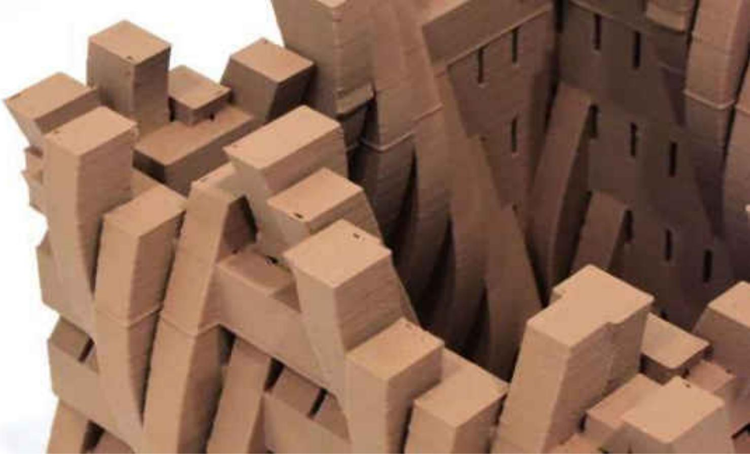
使用的木塑 PLA 材料是一种环保型的材料。已经成为一个不可忽视的重要因素。这种材料可降塑，木塑 PLA 环保无污染,可生物降解，接近木质的效果，打印过程中并带有木质的气味，收缩率低,易打印，强度高,刚性强，适合打印工艺品、艺术品以及工业设计样品等。让设计师们能够更好地创造出具有多样性、创意性和实用性的作品。让设计更具可持续性。这种环保材料的使用，一方面体现了设计的责任和关怀，另一方面也能够为设计师们带来更多的灵感和思考。
